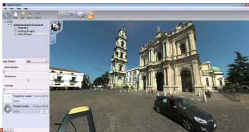
19. Pompei, Piazza Bartolo Longo. Modello tridimensionale nuvola di punti texturizzato con immagini nel visibile da acquisizione Mobile Mapping Topcon IP-S2 [2012].
